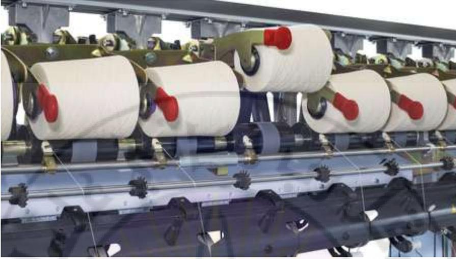
الشكل (2-36): آلة تدوير بالاحتكاك للمعبوة Friction drive of a package
