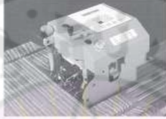
الشكل (3-4): آلة عقد (ربط) خيوط السداء (Fischer Poege) Warp tying machine. (Adanur, S.,2001)
