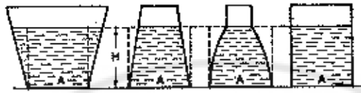
الشكل ١٢.٣ : التناقض الهيدروستاتيكية : قوة الضغط على قعر الأوعية المختلفة الأشكال واحدة .
