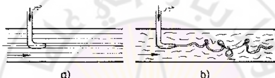
الشكل ٣.٥ : تجربة رينولدز لتوضيح الجريانات الصفائحي حيث V < V_{cr} (a) ؛ والمضطرب حيث V > V_{cr} (b) .
