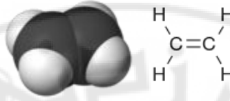
الشكل 4-21: الوحدات المتكررة في البولي إيثيلين مع إظهار الكيمياء الفراغية
