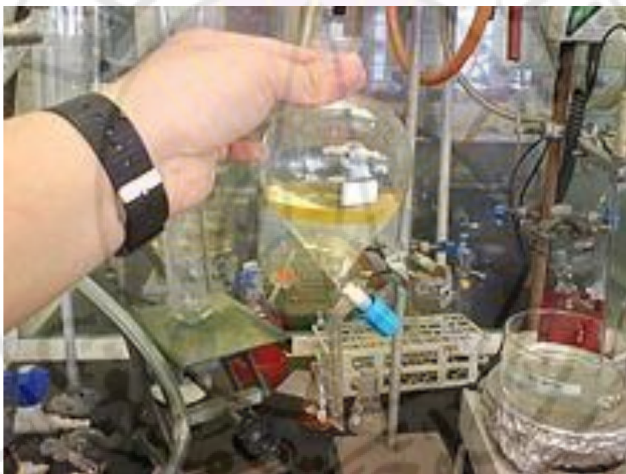
الشكل 8-10: استخراج السائل - السائل على نطاق المختبر. صورة لمسار فاصل في استخراج مقياس مختبري لسائلين غير قابلين للمزج: السوائل هي مرحلة عليا من الأثير الديثيل، ومرحلة مائية أقل
