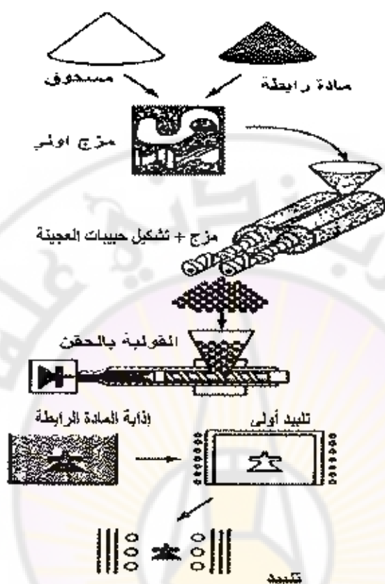
الشكل (١٧-٤) المخطط التكنولوجي لعملية التدميج بالحقن
