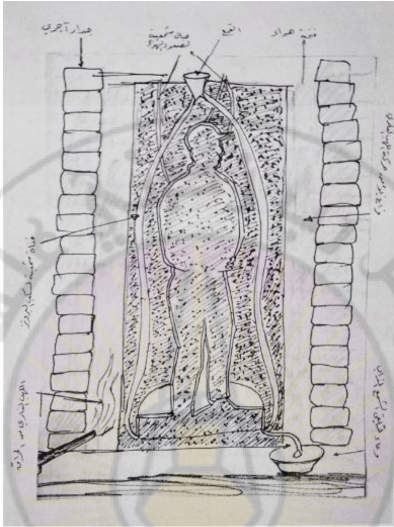
الشكل (7) شكل تمثيلي لصب البرونز
