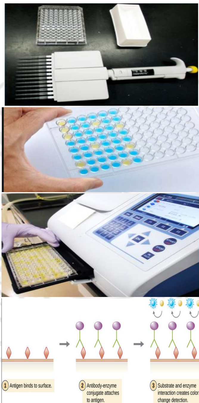
الشكل (21): خطوات عمل الإليزا
