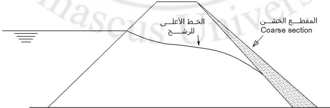
الشكل (١٤-٤) مرشح المقطع الخشن D\S coarse section
