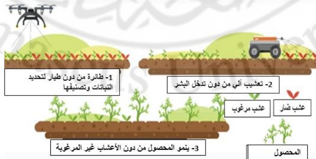
شكل (19) آلية التحكم بالتعشيب الآلي عن بعد
