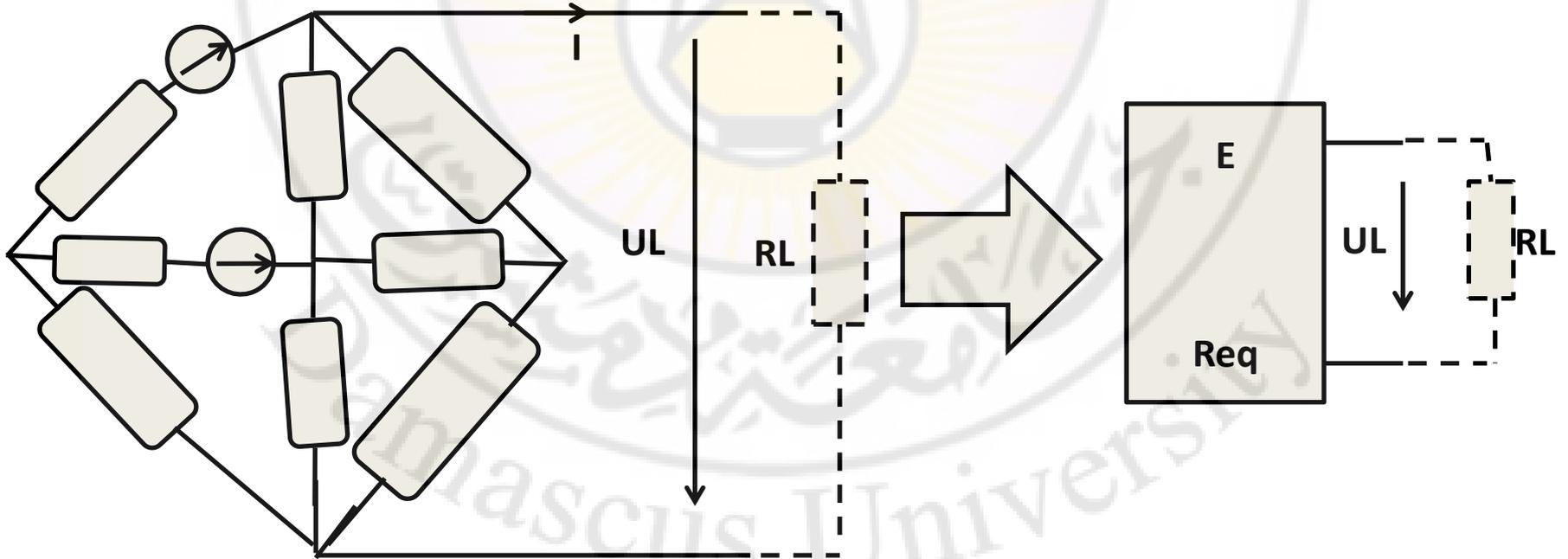
تفيد نظرية ثيفيتين المكافئة في إيجاد الاستطاعة العظمى الممكن نقلها إلى الحمل في دارة خطية حيث افترضنا أنه يمكن ضبط مقاومة الحمل RL إذا استبدلنا الدارة بأكملها بدارة ثيفتين المكافئة لها باستثناء مقاومة الحمل أي:
