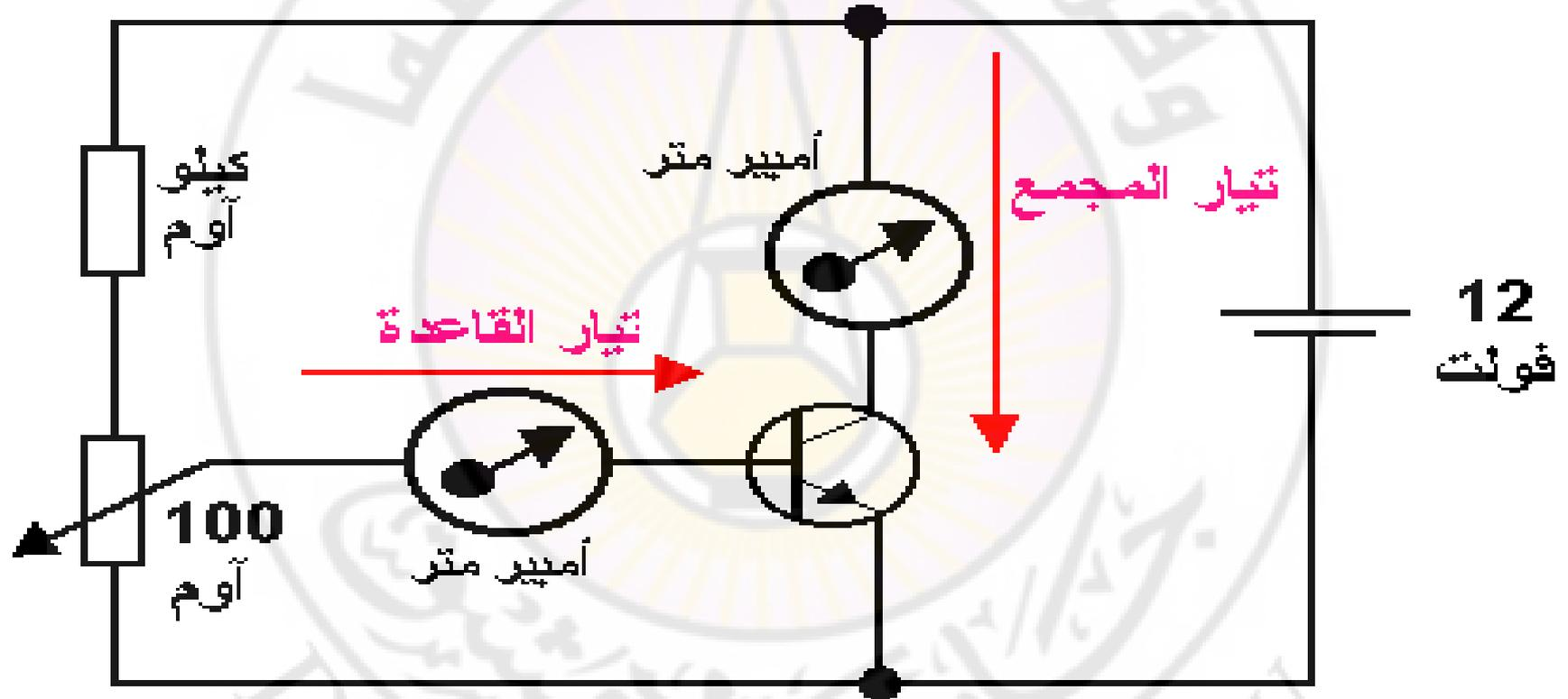
دائرة اختبار عامل تكبير التيار في الترانزيستور
