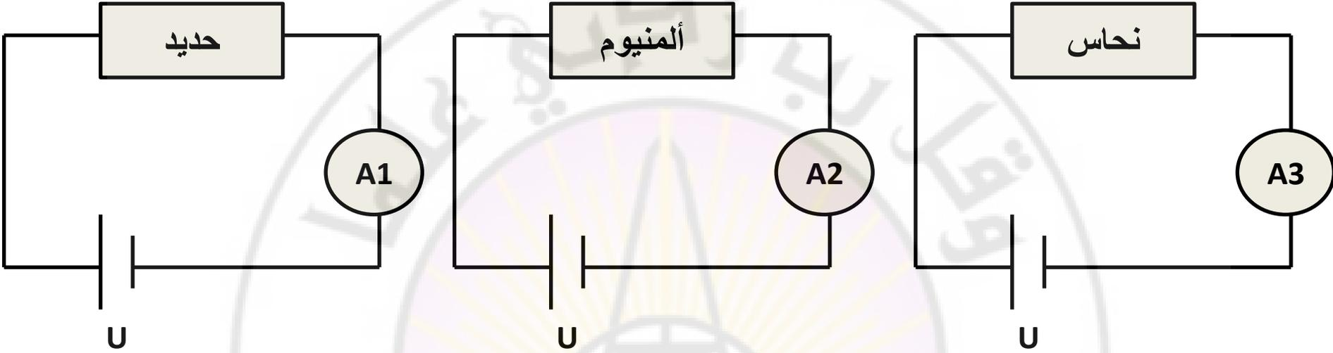
وبواسطة مقاييس الأمبير الموجودة في كل دائرة نلاحظ أن هناك قيماً مختلفة للتيارات المقاسة، حيث تتعلق قيم هذه التيارات بالتركيب الداخلي للمادة المصنوع منه الناقل، أي أن المواد تبدي مقاومة مختلفة للتيار عند تطبيق توتر معين ثابت، ومن هنا يمكن تعريف كمية فيزيائية جديدة تسمى المقاومة النوعية للمادة ويرمز لها بالرمز  $P$ .
