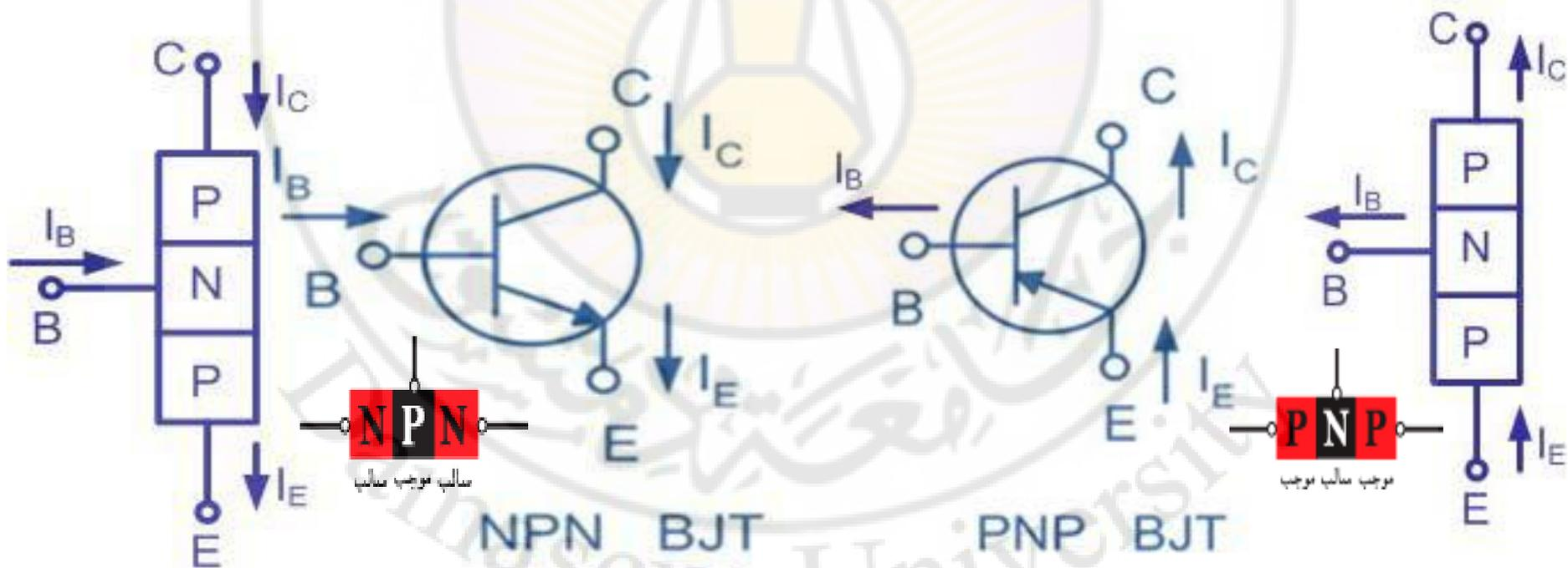
يختلف الشكلين NPN عن PNP باتجاه التيار المار فقط، حيث يسلك التيار اتجاه واحد فقط هو اتجاه تدفق حوامل الشحنة الأكثرية.
