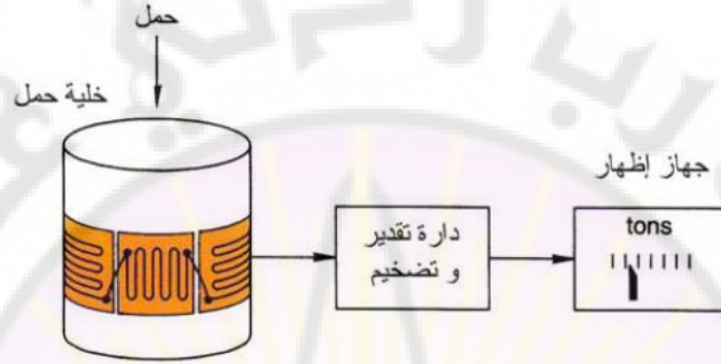
الشكل (24-1) قياس القوة باستخدام حساس خلية التحميل ذو مقياس الانفعال
